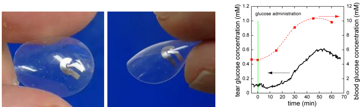
図2 コンタクトレンズ型バイオセンサの外観写真（左）、経口ブドウ糖負荷試験での家兔涙液糖（実線）と血糖値（破線）の比較（右） [2]
